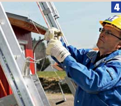
4. Schlitten am Seil der Winde befestigen
