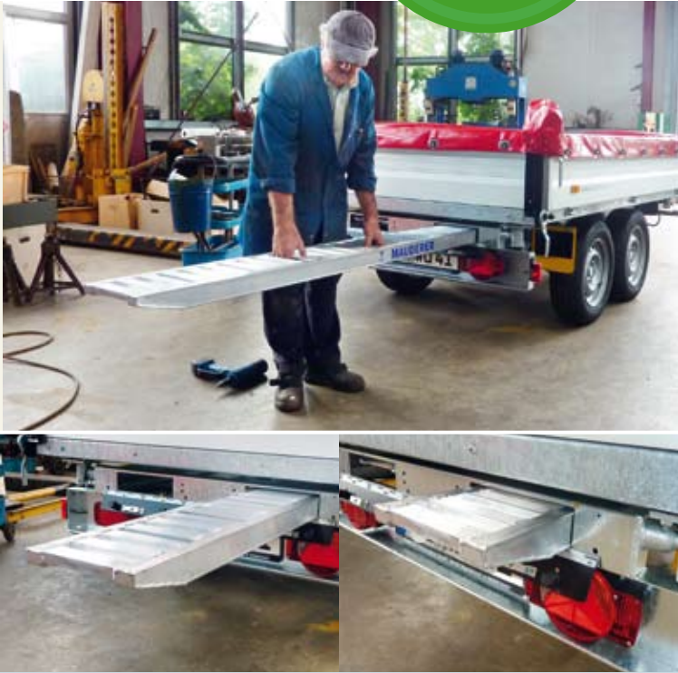
Baytec-Kompakt-Verladeschienen passen exakt in die Einschubfächer von gängigen Anhängern.
