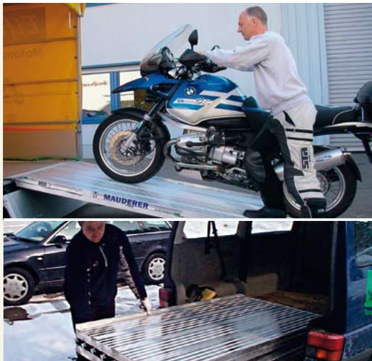
Benötigt nur den halben Stauraum bei ganzem Nutzen – die klappbare Version des Verladestegs.
