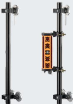
» Magnethalterung zur Befestigung am Löffelstiel des Baggers. Der Maschinenempfänger kann unter einfacher Handhabung auf die Höhe der Rotationslaserebene eingerichtet werden. Starke Magnete sichern rutschfesten Halt. Einfaches Lösen durch fest montierten Metallhebel am oberen Magnet. Kompatibel mit allen Maschinenempfängern mit Schraubklemmen.
