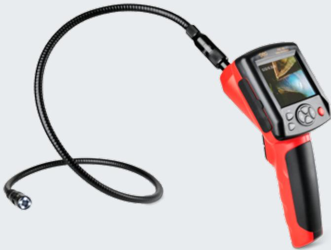
» Zur optischen Untersuchung schwer zugänglicher Bereiche. Mit Speichermöglichkeit von Bildern und Videosequenzen zur Dokumentation.
