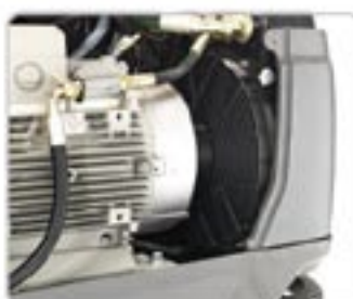
Elektrogebläse für maximale Kühlung.
