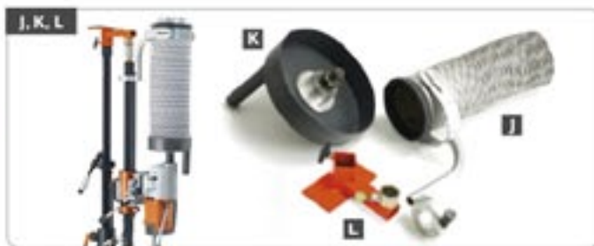
Wasserauffangvorrichtung zum vertikalen Überkopfbohren mit einem elektrischen Bohrmotor, einschliesslich Telleraufnahme für Auffangvorrichtung, Auffangvorrichtung und Deckenbefestigungshilfe.
