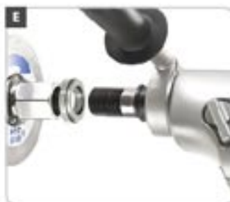
Der Bohrkronenzieher erleichtert das ziehen der Bohrkronen.
