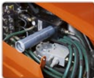
Fettpumpe und automatisches Schmiersystem serienmäßig für die Arbeitsgeräte.
