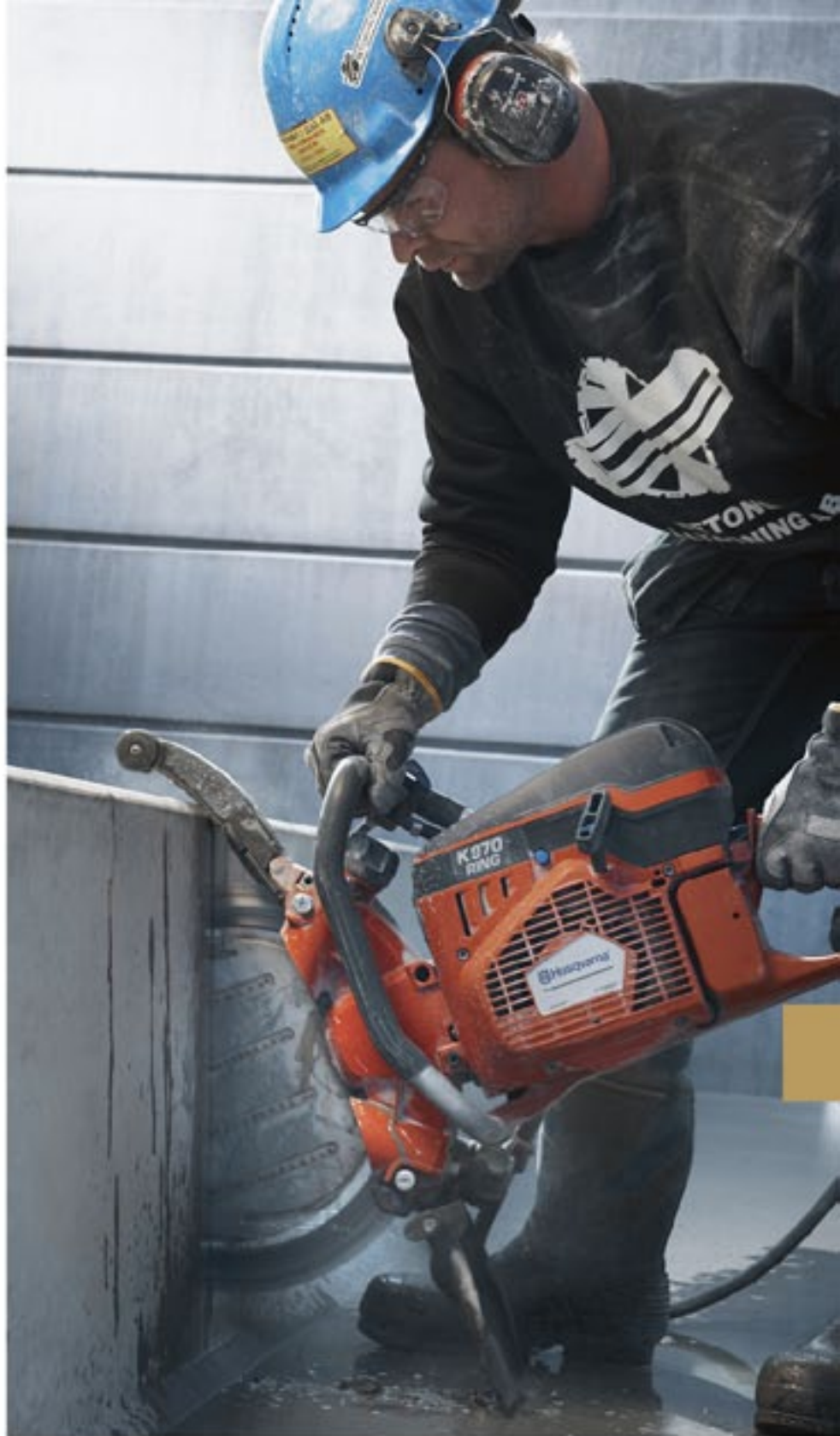
270 mm Schnitttiefe, zweifache Tiefe einer herkömmlichen Trennscheibe.
