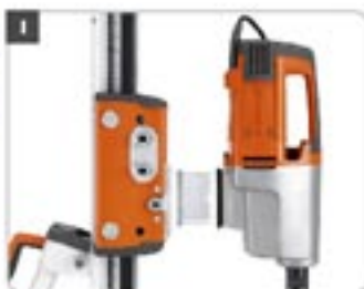
I Distanzplatte mit Schnellverschlüssen für Bohrungen mit grösseren Bohrkronen. 50 mm Distanzstück.
