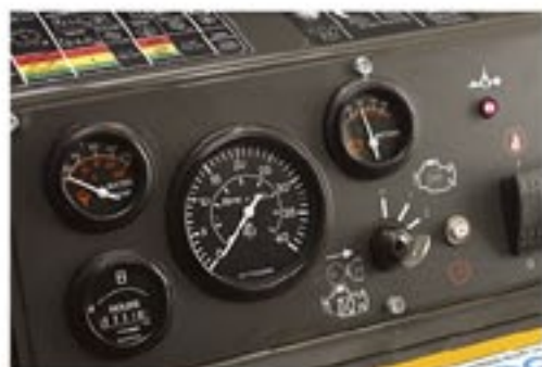
Der Drehzahlmesser für Motor/Schneidwelle zeigt die Motor- bzw. die Schneidwellendrehzahl an. Der Bereich für die Schneidwellendrehzahl ist farbcodiert, um den gewünschten Gang einzulegen.
