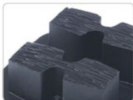
Die Husqvarna Segmentform ermöglicht mehr aktive Diamanten als herkömmliche rechteckige Alternativen und somit mehr „Biss“ beim Schleifen. Dank der vorgeschliffenen Segmente können die Diamantwerkzeuge sofort mit hundertprozentiger Effizienz arbeiten – ohne vorheriges Abrichten.
