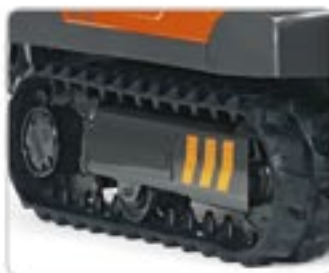
Serienmäßig mit hydraulischer Bandspannung.
