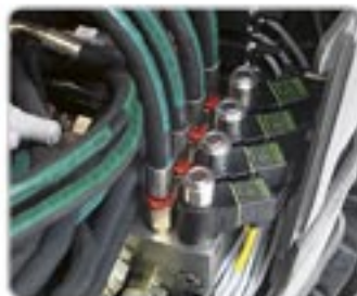
Steckverbindungen zum Wechseln von Schläuchen ohne Werkzeug.
