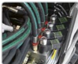
Steckverbindungen zum Wechseln von Schläuchen ohne Werkzeug.
