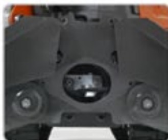
Leichter Zugriff zum Lösen der Kettenspannung.
