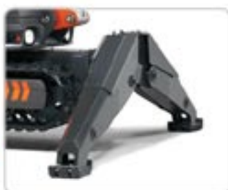
Für überlegene Stabilität und hohe Arbeitsbelastung haben die Ausleger eine extra breite Spannweite.
